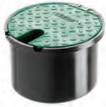
Die für den Durchgang des Schlauchs geformt ist. Der Anschluss an die unterirdische Anlage erfolgt über einen der beiden Auslässe mit 3/4"-Innengewinde, die sich unten und an der Seite befinden. Im Lieferumfang enthalten ist eine Kappe mit O-Ring zum Verschließen des unbenutzten Ausgangs. Im Inneren befindet sich ein für den einfachen Anschluss eines Schlauchs. Löcher im Boden gestatten den Wasserabfluss.
