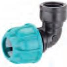
Klemmverbinder für PE-Rohre, zur schnell und sicheren Verschraubung ohne Werkzeuge an 3/4" Adapter AG oder an 3/4" Ablassventil am Leitungsende.
