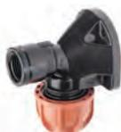
Gebogene Wandplakette für den Anschluss eines 20-mm-Polyethylenschlauchs und eines Wasserhahns mit 1/2"-AG-Kupplung, wodurch ein neuer, an die Anlage angeschlossener Wasserauslass entsteht. Wandbefestigung mit Schrauben und Dübeln (nicht im Lieferumfang enthalten).
