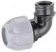
Klemmverbinder für PE-Rohre, zur schnell und sicheren Verschraubung ohne Werkzeuge an 3/4" Adapter oder an 3/4" Ablassventils am Leitungsende.
