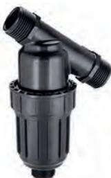
Polypropylen-Filter mit doppeltem 1" AG Anschlüsse. Filterpatrone aus Edelstahl mit Partikelfilter 120 Mesh. Maximale Durchfluss 5 m<sup>3</sup>/Std. - Betriebsdruck von 0,5 bis 8 Bar.
