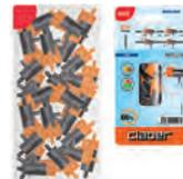
Die Tropfer sind für den Anschluss in Reihe bestimmt. Endtropfer mit regulierbare Wassermenge von 0-6 L/Std., von ganz geschlossen bis ganz offen. Präzise und abgestimmte Einstellung des Wasserflusses. Wird mit einem einfachen und perfekt dichten Stechverbinder direkt am 1/4" Verteilerrohr (4 - 6 mm) angeschlossen. Zugänglich für eine einfache Reinigung. Blister mit 10 Stück.
