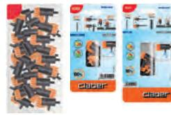
Endtropfer mit regulierbare Wassermenge von 0-6 L/Std., von ganz geschlossen bis ganz offen. Präzise und abgestimmte Einstellung des Wasserflusses. Wird mit einem einfachen und perfekt dichten Stechverbinder direkt an das Ende des 1/4" Verteilerrohr (4 - 6 mm) angeschlossen. Zugänglich für eine einfache Reinigung.
