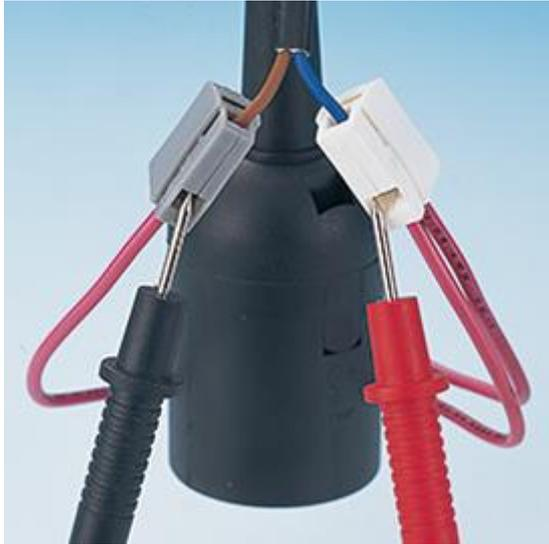
Verwenden Sie einen Spannungsprüfer, um Ihre Verbindung zu testen.
