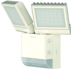
LED-Strahler für Wandmontage mit Bewegungsmelder, weiss, 4000 K, 2x900 lm, 2 LED-Strahler mit insgesamt 17 W, Erfassungsbereich 180° 10 m, zusätzlicher Schaltausgang Licht, vernetzbar über Draht
