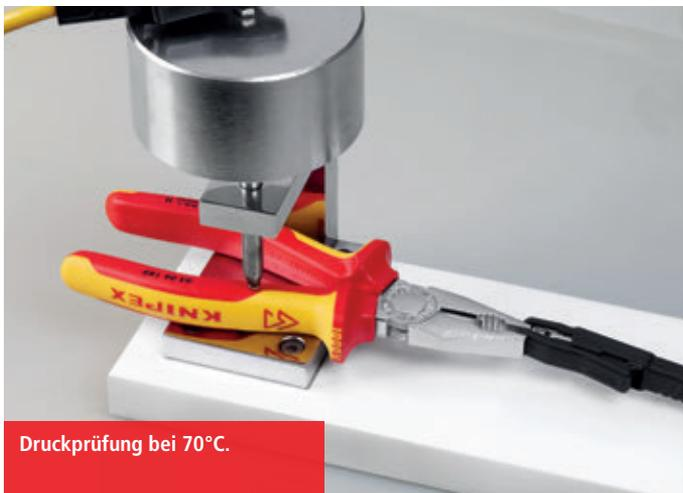
Druckprüfung bei 70°C.
