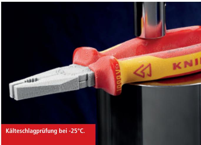
Kälteschlagprüfung bei -25°C.
