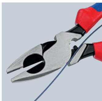
09 11/12 240: Kabel-Einziehhilfe im Gelenkspalt
