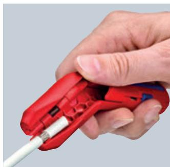
Abmanteln eines Koaxialkabels
