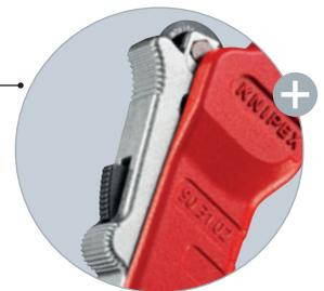
Durch die Einhandschnellverstellung kann das abgedeferte Schneidrad an den Durchmesser des Rohres herangeschoben und fixiert werden
