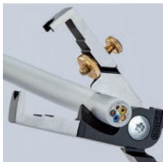
Induktiv gehärtete Scherschneide mit Präzisionsschliff zum quetschfreien Schneiden von Cu- und Al-Kabeln bis Ø 15 mm (5 x 2,5 mm<sup>2</sup>)
