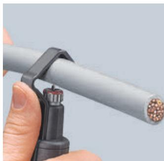
Ansetzen des Werkzeugs für Umfangsschnitt
