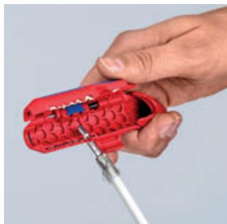
Abisolieren eines Koaxialkabels
