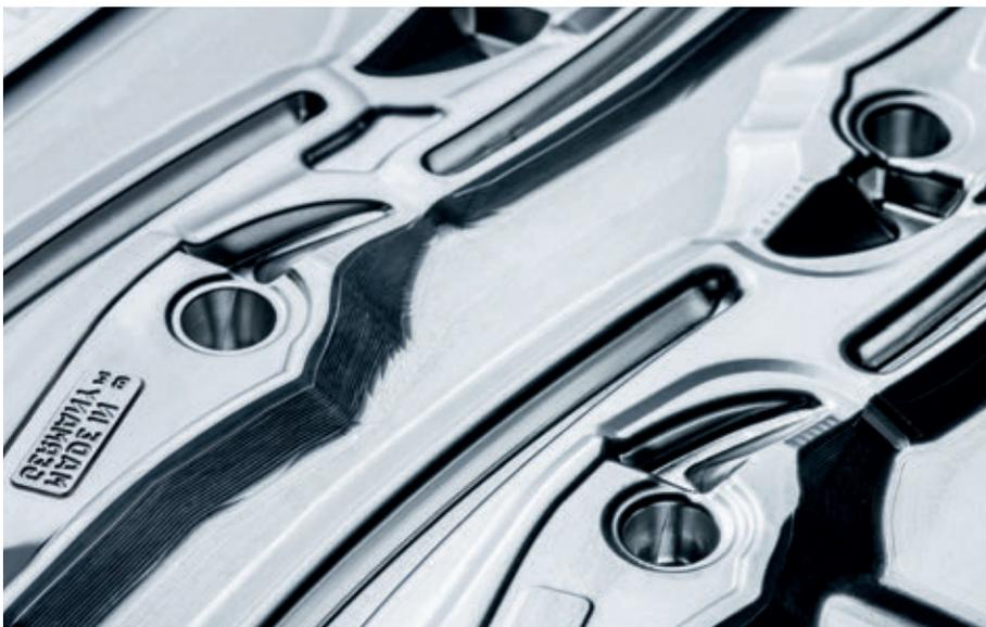
Schmiedegesenk für den Kraft-Seitenschneider mit angeschmiedeter Gelenkachse.
