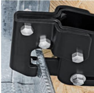
Das Stempelwerkzeug wird durch die Profilbleche gedrückt
