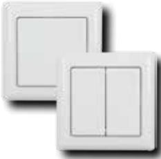
**Eltako** Erzeugt Energie für Funktelegramme selbst beim Tastendruck, daher ohne Anschlussleitung und kein Stand-by-Verlust. 80 x 80 mm außen, Rahmen-Innenmaß 55 x 55 mm, 15 mm hoch. **Lieferumfang:** 1x Rahmen R, 1x Wippe W55, 1x Doppelwippe DW55, 1x Befestigungsrahmen BRF, 1x Halteplatte HP, 1x Funkmodul und 1x Klebefolie.
