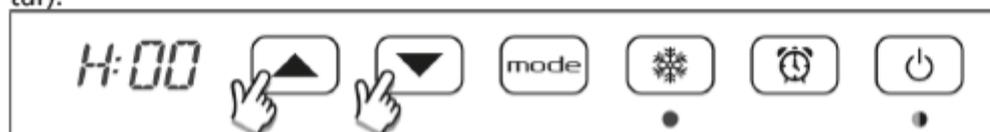
Die Referenz-Temperatur kann durch Drücken der „Mode“-Taste geändert werden. Eine rote LED zu den jeweiligen Temperaturen der Modi erscheint in Folge.
