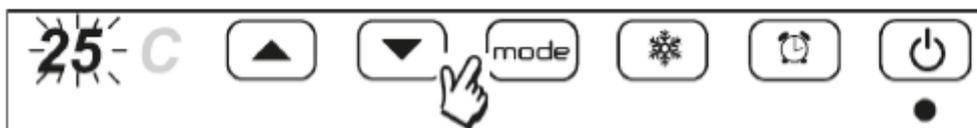
Ist die Temperatur von 23°C zu niedrig oder zu hoch erstellt man mit den  $\uparrow$  $\downarrow$ -Tasten in 1°C Schritten die Temperatur. Mit der Mode-Taste bestätigen. Die Programmierung ist abgeschlossen, das Gerät ist im Standby-Betrieb. Im Display erscheint die eingestellte Tageszeit.
