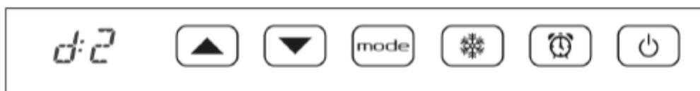
Es ist möglich jede Stunde des 2. Tages zu einzustellen oder diesen Tag identisch zum ersten Tag zu programmieren. Für die individuelle Programmierung verfahren Sie wie oben beschrieben. Zur Übernahme der Daten aus dem ersten Tag muss nur die Taste „Mode“ gedrückt werden. Anschließend wird zum dritten Tag weitergeleitet. Diese Verfahren können bis zum 7. Tag wiederholt werden:
