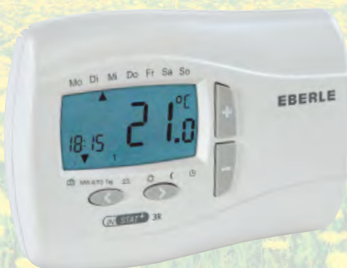
Instat +3r Art. Nr. 080301 Display-Thermostat für Heizpaneele aller Art, mit Wochentags- programm, in weiß, 230V/16A, mit Aus- und Einschalter, Schutzklasse IP20, Regelbereich: 7 - 32°C, Abmessung: 137 x 96 x 31 mm, Aufputzausführung.
