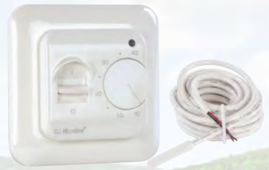
OTN-1991H11 Art. Nr. 080202 Standard-Thermostat für Heizpaneele aller Art, in weiß, 230V/16A, Aus-/Einschalter und Fußbodenfühler Schutzklasse IP21, Regelbereich: 5-40°C, Abmessung: 75 x 75 x 27,5 mm, Schalterdosen Montage Unterputz.
