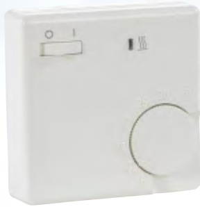
RTR3502 Art. Nr. 080101 Standard-Thermostat für Heizpaneele aller Art, in weiß, 230V/16A, mit Aus- u. Einschalter, Schutzklasse IP30, Regelbereich: 5 - 30°C Abmessung: 75 x 75 x 27,5 mm Aufputzausführung.
