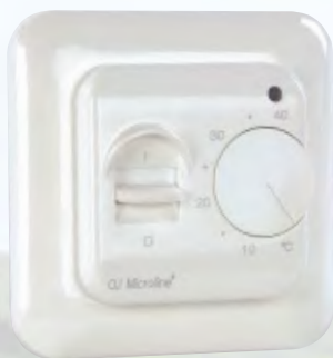
OTN-1999H Art. Nr. 080201 Standard-Thermostat für Heizpaneele aller Art, in weiß, 230V/16A, mit Aus- u. Einschalter, Schutzklasse IP20, Regelbereich: 5 - 40°C, Abmessung: 75 x 75 x 27,5 mm, Schalterdosen Montage Unterputz.
