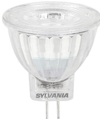
LED-MR11-Serie mit dem gleichen Look and Feel wie eine traditionelle Halogen-MR11-Lampe. Vollglasdesign – verhindert Farbkonflikte zwischen Lampe und Leuchte. Verfügbar mit 36° Abstrahlwinkel. Durchschnittliche Nennlebensdauer: 15.000 Stunden. Schaltzyklen: 50.000. Farbwiedergabe: CRI80. Lampenspannung: 12V AC/DC. Funktioniert mit magnetischen und kompatiblen elektronischen Transformatoren\*. Garantie: 3 Jahre.
