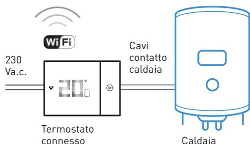
Il nuovo termostato connesso, è la soluzione ideale sia in caso di nuova installazione, che di sostituzione di un vecchio termostato. Da incasso o da parete, la messa in opera del termostato connesso risulta facile. Unico accorgimento: in caso di sostituzione di un vecchio termostato a pile, sarà necessario predisporre due cavi per l'alimentazione 230 V.a.c.
