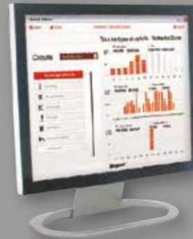
Auf einem PC: den Betriebsstatus der Ladestation anzeigen, den Energieverbrauch messen, die verfügbare Energie optimieren (Steuerung des Ladevorgangs durch Aufteilen der Energie zwischen den verschiedenen Ladestationen).
