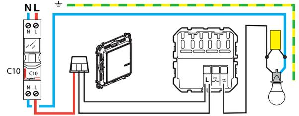
Verwenden Sie eine Klemme, um alle 3 Drähte miteinander zu verbinden (die beiden Korrespondierenden und den Außenleiter). Verwenden Sie eine eigene Klemme, um den Neutralleiter zu isolieren (falls vorhanden).
