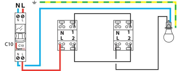
**Ersetzen eines vorhandenen Wechselschalters durch einen vernetzten Schalter + drahtlosen Lichtschalter.**
