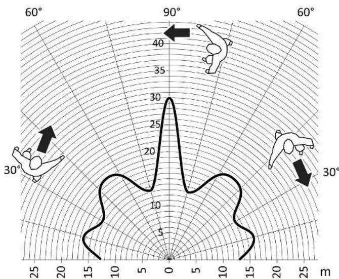
Bild 4: Reichweite bei tangentialer Bewegungsrichtung Bewegungsmelder 1,10 m Art.-Nr. ..17182..
