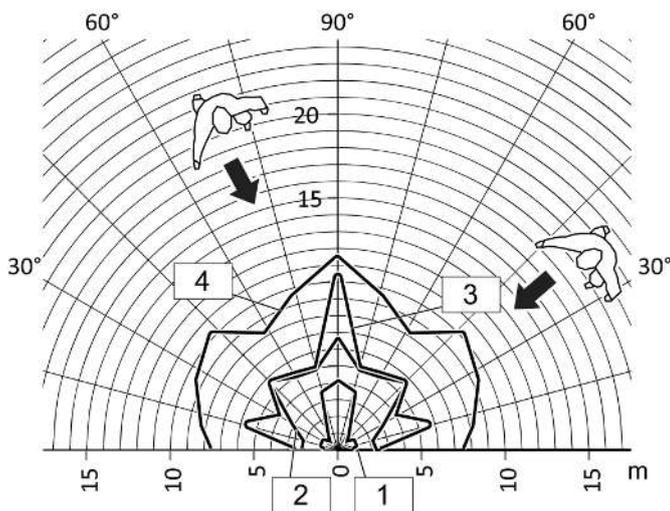
Bild 3: Reichweite bei radialer Bewegungsrichtung Bewegungsmelder 1,10 m Art.-Nr. ..17180..
