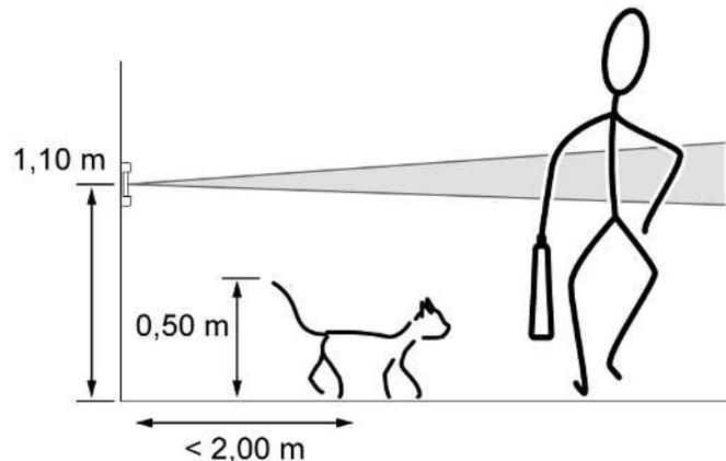
Bild 1: Erfassungsfeld und Einbauhöhe Bewegungsmelder 1,10 m
