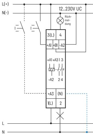
Bei angeschlossenem N ist die Kontaktschaltung im Nulldurchgang aktiv.
