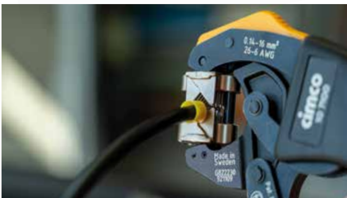
Seitliche Zuführung der Aderendhülse.
