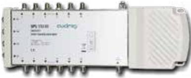
**SAT- und terrestrisch aktiv.** Multischalter. 5 Eingänge. 12 Teilnehmerausgänge. Leistungsaufnahme: 6 W. Anschlußdämpfung SAT: 6...10 dB. Schaltnetzteil: 90...250 V~/47...63 Hz. Ausgangsspannung: 18V=0,5A.
