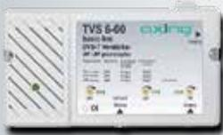
Mit Eingang für UKW und Kombi-Eingang für VHF/UHF. VHF/UHF-Eingangspiegel getrennt regelbar. Verstärkung 24 dB. Integriertes Steckernetzteil 230V~/50Hz. Leistungsaufnahme 3 W.
