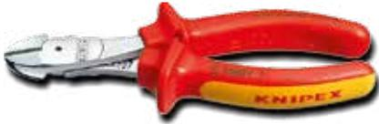
Schneidhärte ca. 64 HRC für alle Drahtsorten einschließlich Pianodraht Ø 2,5 mm. VDE-geprüft. Isolationsnorm IEC 60900. DIN EN 60900. ASTM F1505.
