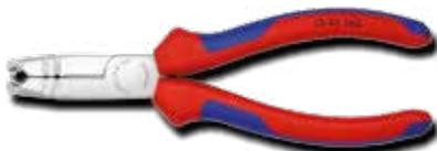
Multifunktional - Schneiden, Abmanteln und Abisolieren mit einer Zange. Schneidewerte mittelharter Draht Ø 3,2. | harter Draht Ø 2,2. Abisolierwerte 0,75 — 1,5 mm<sup>2</sup> | 2,5 mm<sup>2</sup>.
