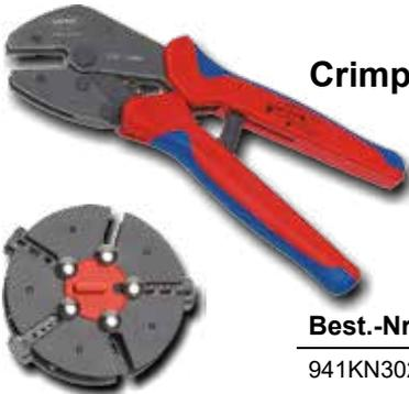
Mit Rundmagazin und 5 Wechseleinsätzen für unisolierte, offene Steckverbinder (4,8 + 6,3 mm Steckerbreite) von 0,5 - 6,0 mm<sup>2</sup>; isolierte Kabelschuhe + Steckverbinder von 0,5 - 6,0 mm<sup>2</sup>; Aderendhülsen von 0,25 - 6,0 mm<sup>2</sup>; unisolierte Kabelschuhe und Steckverbinder von 0,5 - 10 mm<sup>2</sup>; unisolierte Stoßverbinder von 1,5 - 10 mm<sup>2</sup>.
