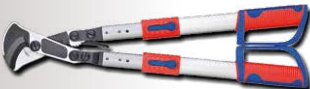
Zweihand-Kabelschere zum Schneiden von CU- und AL-Kabeln, ein- und mehrdrähtig. Schneidbereich: max.  $\varnothing 38$  mm (z.B. 4 x 70 mm² NYY). Nicht für Stahldraht, hartgezogene Kupferleiter oder Drahtseile geeignet! **Teleskopschenkel abwinkelbar und mehrstufig verstellbar von 550 - 770 mm.**
