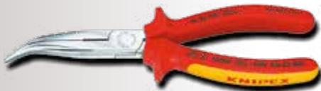
Hoch belastbare, elastische Präzisionsspitzen. Für mittelharten Draht  $\varnothing 3,2$  mm und harten Draht  $\varnothing 2,2$  mm. Schneidhärte ca. 61 HRC. VDE geprüft. IEC 60900. DIN EN 60900. ASTM F1505.
