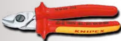
Zum Schneiden von Cu- und Al-Kabeln, ein- und mehrdrähtig. Nicht für Stahldraht und hartgezogene Kupferleiter geeignet. VDE-geprüft. IEC 60900. DIN EN 60900. ASTM F1505.
