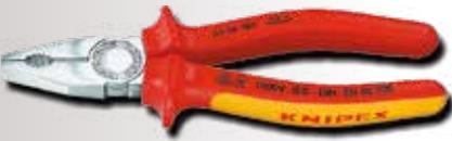
Schneidhärte ca. 60 HRC Spezial-Werkzeugstahl. VDE geprüft. IEC 60900. DIN EN 60900. ASTM F1505.
