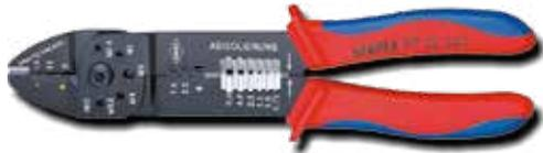
**3 Nester.** Mit Gewindelöchern zum Abschneiden von Cu- oder Ms-Gewindestiften mit M 2,6; 3,0; 3,5; 4,0 und 5,0 mm. Kapazität 0,75 - 6,0 mm<sup>2</sup> / AWG 18 - 10.
